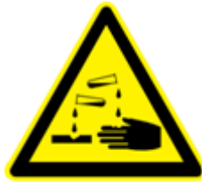
Gambar 3.9 Lambang bahan kimia korosif/corrosive. lambang tetesan cairan yang mengenai logam atau tangan. Lambang tersebut menunjukkan cairan asam dapat merusak logam dan tubuh manusia
