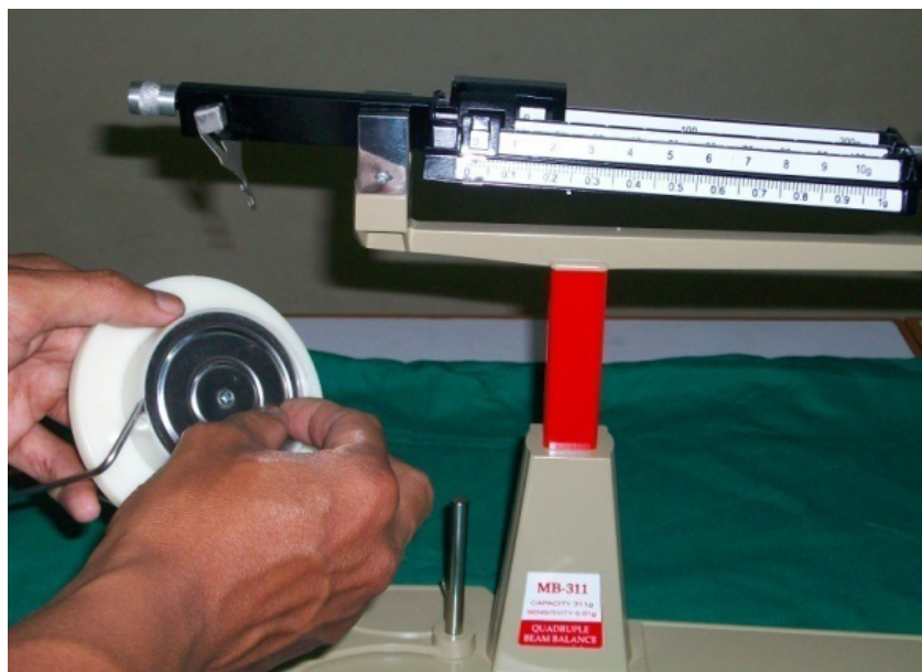
Gambar 2.17 Mengurangi atau menambah peluru
