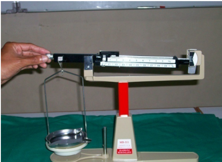
Gambar 2.16 Memutar sekrup pada neraca
