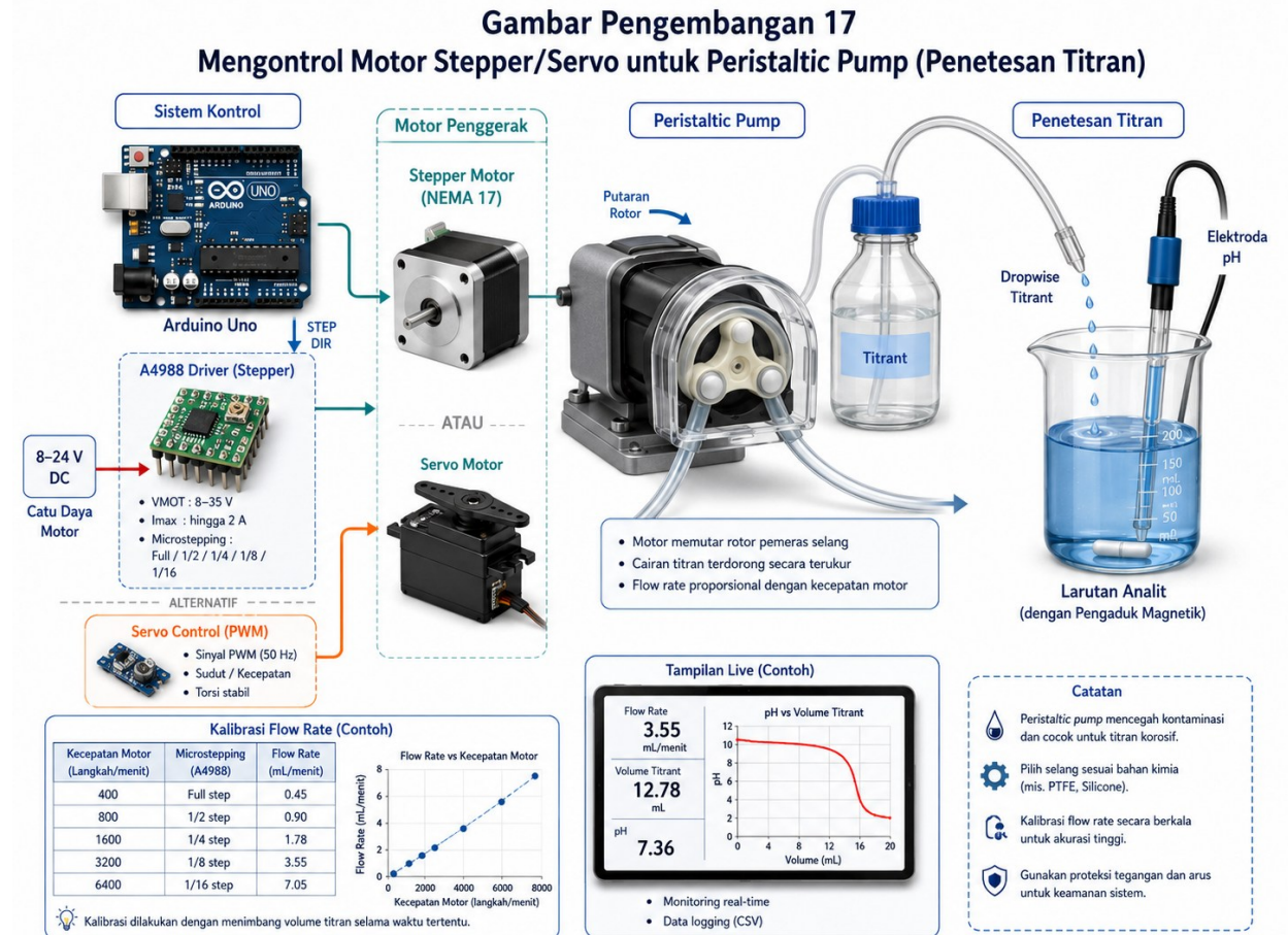
Gambar Pengembangan 17. Ilustrasi konseptual alur sensor, mikrokontroler, dan interpretasi data untuk subbab 4.3. Mengontrol Motor Stepper/Servo untuk Peristaltic Pump (Penetesan Titran).
