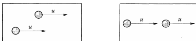
Gambar 4.3 Dua partikel berkecepatan sama: (a) bergerak pada lintasan sejajar; (b) bergerak pada lintasan yang sama dan bertumbukan.
